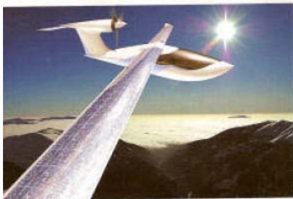
L'Hybird puise son énergie dans ses panneaux solaires.
